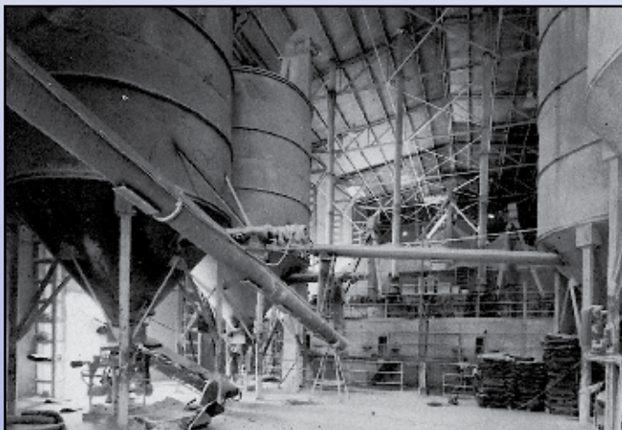
SCREW CONVEYOR FOR TRANSPORT OF RAW MATERIALS FOR CERAMIC GLAZINGS FÖRERSCHNECKE FÜR ROHPRODUKTE ZUR HERSTELLUNG VON KERAMIK EINBRENNEMAILLE VIS TUBULAIRE TRANSPORT MATIERES PREMIERES POUR LAQUES CERAMIQUES COCLEA TRASPORTO MATERIE PRIME PER SMALTI CERAMICI
