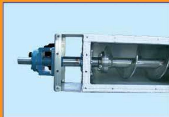
Spacer for heat insulation Abstandhalter zur Wärmeisolation Entretoise d'isolation Distanziale d'isolamento
