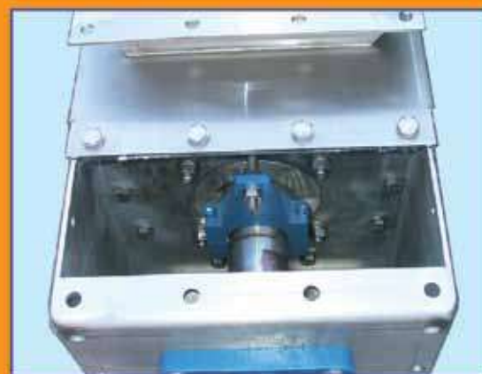
High quality seal and split gland Qualitätsabdichtung und geteilte Stopfbuchsenbrille Étanchéité d'haute qualité et presse-étoupe sectionnée Tenuta ad alta qualità con premibaderna sezionata
