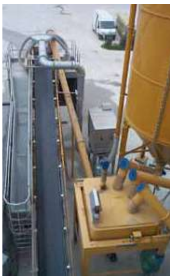
Weigh hopper loaded by screw feeder Behälterwaage durch Dosierschnecke befüllt Trémie alimentée par vis doseuse Dosatore alimentato da codlea estraitrice da silo
