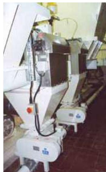
Blow-through rotary valve and pneumatic conveying system Durchblasseleuse und pneumatische Förderung Trémie d'écluse rotative pour transport pneumatique Sfilato rotocella con trasporto pneumatico
