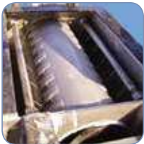
Sección de la salida del compactador con sistema de lavado (opcional)
