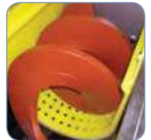
Tamiz de drenaje ajustable y autolimpiable
