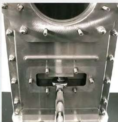
Ajuste de cuchilla a través del panel frontal de acceso
