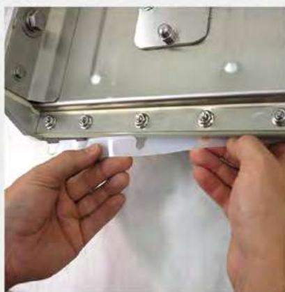
Remoción de empaque para el ajuste del sello mientras la válvula está en línea
