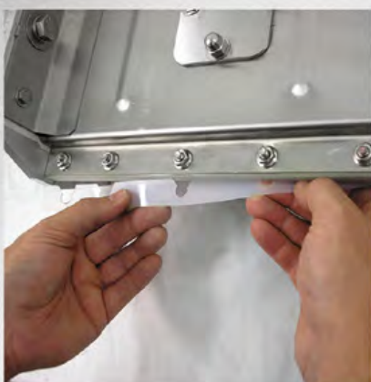
Remoción de las guías para el ajuste de los sellos mientras la válvula está en la línea
