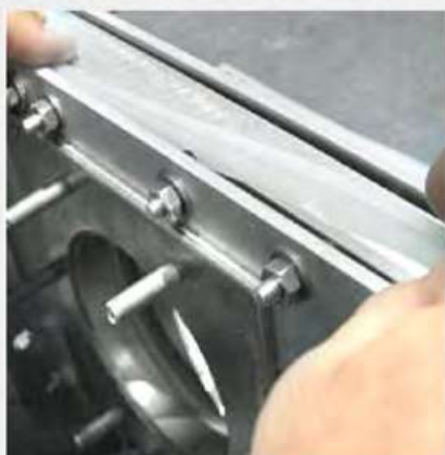
Remoción de las guías para el ajuste de los sellos mientras la válvula está en la línea
