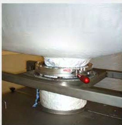
De 12" (305mm) válvula Iris en la descarga de sacos a granel
