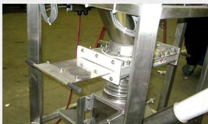
De 6" (152mm) Válvula de orificio de cuchilla manual como válvula de aislamiento arriba de un transportador de tornillo flexible
