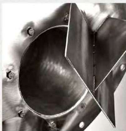
El deflector de material dirige el flujo de material para minimizar el arrastre de material
